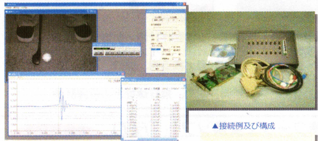
▲ゴルフバットのインパクト瞬間の加速度計と同期動画表示
